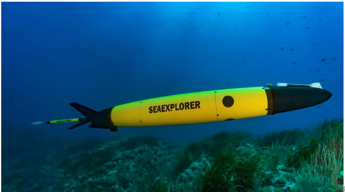
Le SeaExplorer peut évoluer sur l'ensemble de la colonne d'eau, de la surface au fond, grâce à un système planant et une propulsion par ballast
