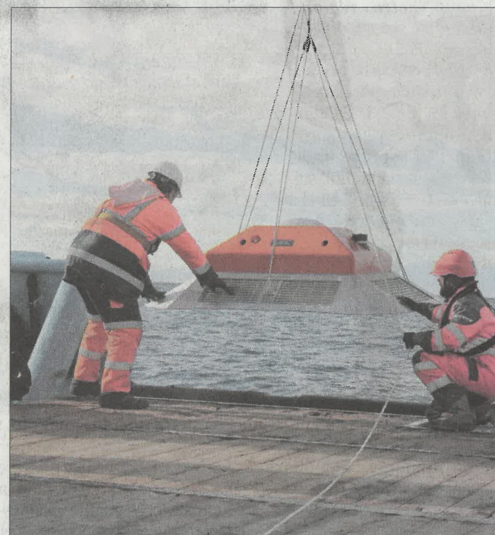
■ Un courantomètre a été placé par Créocéan (à g.) sous l'eau. Biotope utilise des avions pour compter les oiseaux.
